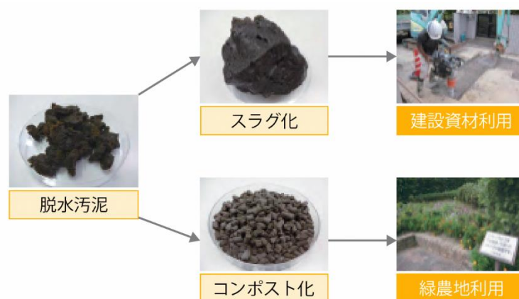
図 3-6-3 脱水汚泥の有効利用
