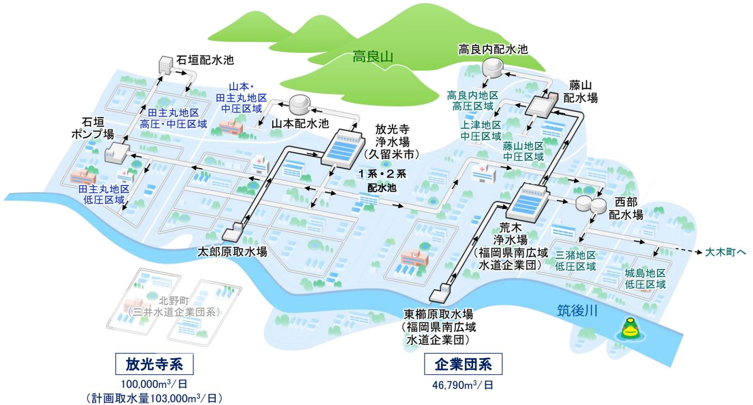
図 2-2-1 久留米市給水区域配水系統図（イメージ）
