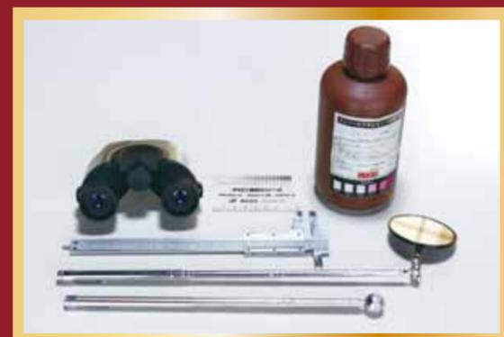
漏水調査の際に使う打診棒などの仕事道具
