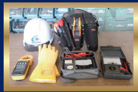
保守点検の際の仕事道具（ヘルメット、ペンチサック、電流計、絶縁手袋、絶縁抵抗計、回路計）
