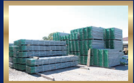
足場の組み立て資材(支柱、アミ付き踏み板、手すり)
