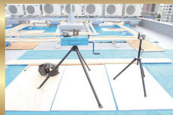
銅管の曲げ加工に使用する直管ベンダー
