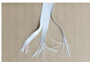
極細番手角ゴム。厚み0.3mm×巾0.48mmの角ゴム。27コールのリボン品の製品化に成功。
