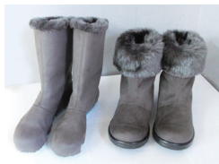
ソール(靴底)を接着する前の アップパー(靴底を除いた部分: 左)と完成した製品(右)。
