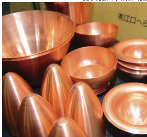
へら鉸りの技術により作成された製品
