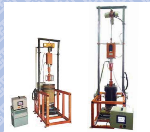
HMA-EXS & HMA-EXL シリンダーライナーホーニング&デグレージング機
