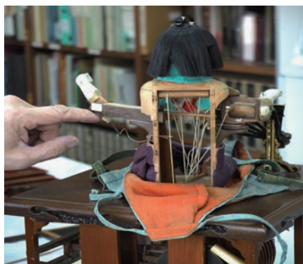
衣服の下に隠れた糸の緩み具合を確認する 木製の部品には「ハ」「ニ」「ホ」と文字が振ってある
