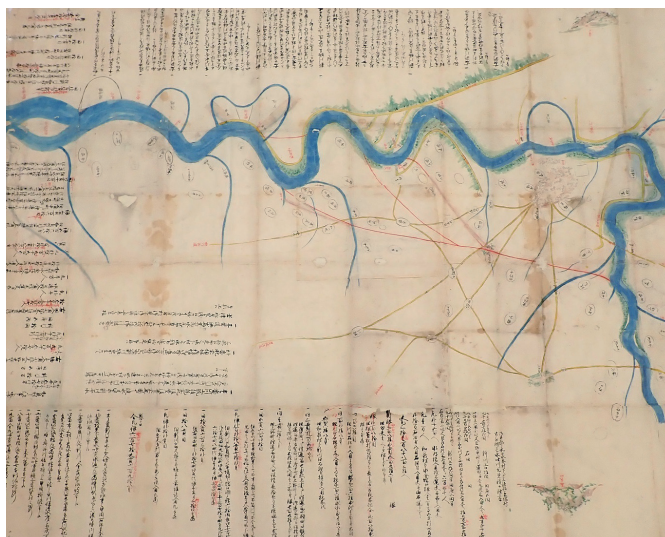
筑後川水吐新川見積絵図(西を上にして撮影)。青は河川、黄色は道、緑は堤防の草木などを示す。筑後川は、画面右下の東から西へ流れ、久留米城付近で南に向きを変える
