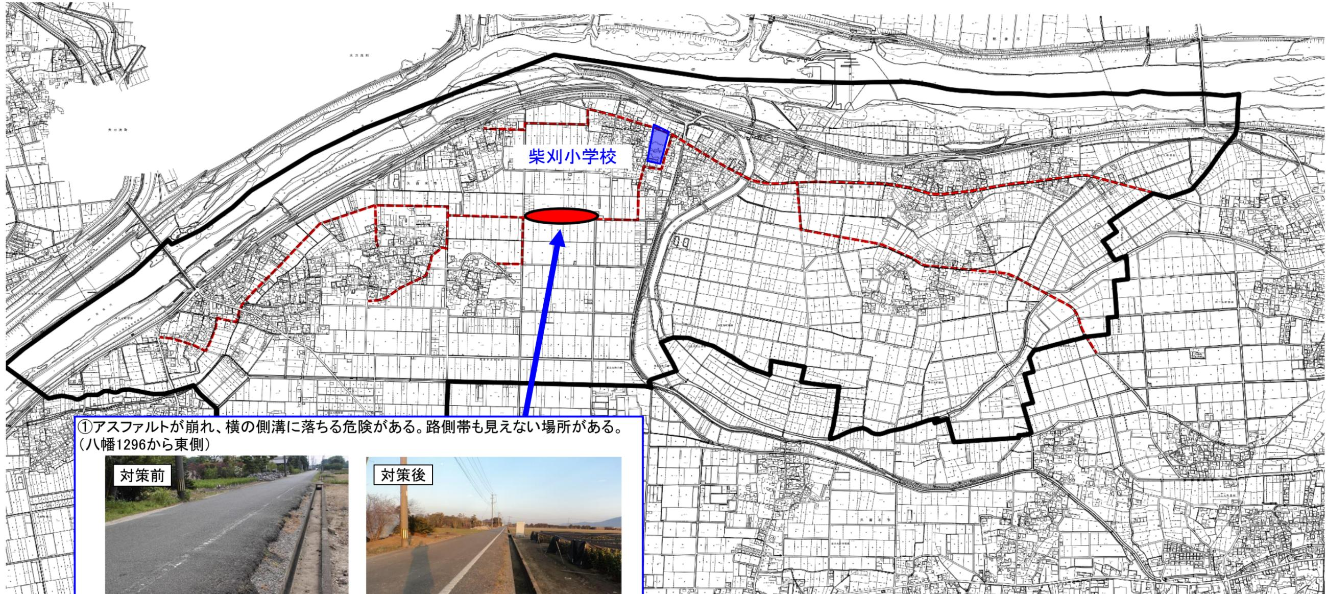
①アスファルトが崩れ、横の側溝に落ちる危険がある。路側帯も見えない場所がある。
