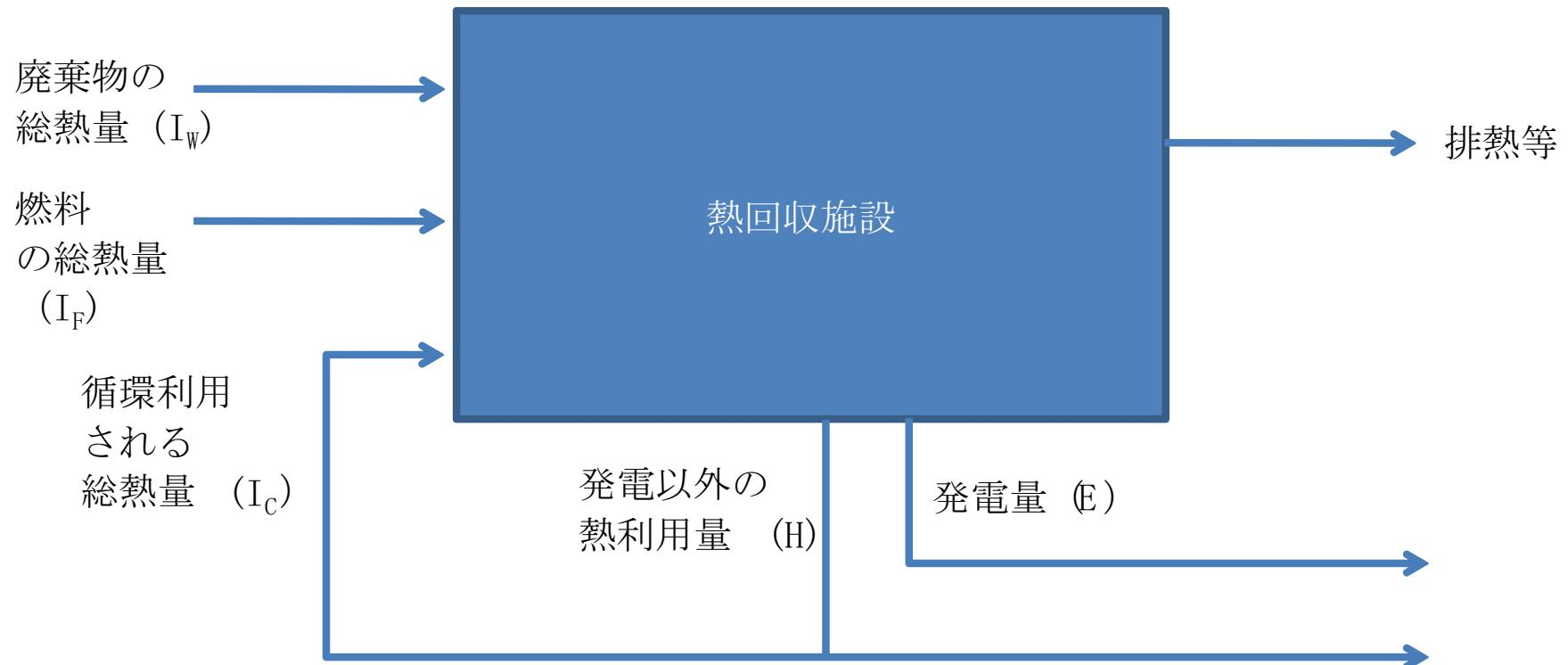
$$\text{熱回収率}(A)[\%] = \frac{\text{発電量}(E)[MWh] \times 3600 + \text{発電以外の熱利用量}(H)[MJ] - \text{燃料の利用に伴い得られる熱量}(F)[MJ]}{\text{投入エネルギー量}(I)[MJ]} \times 100$$
