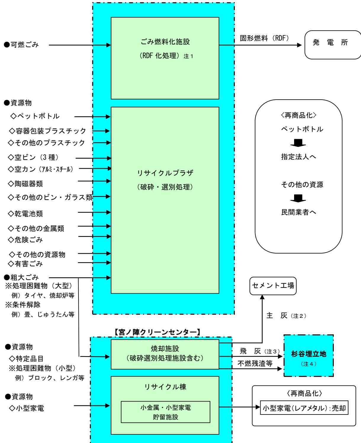
注1：処理方法は、灯油燃焼乾燥方式+圧縮成形方式（RDF）。ごみを破碎・乾燥・成形し、固体燃料（RDF）化する方式。
