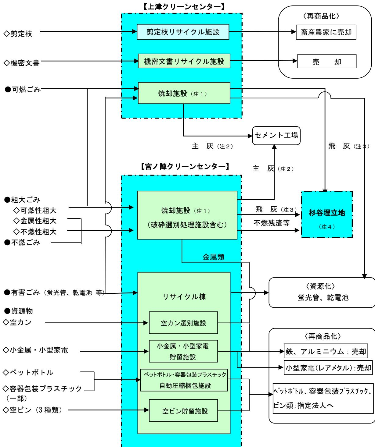
注1：処理方法は、全連続燃焼式（ストーカー炉）。ごみの送り速度と燃焼用空気の量を調整することで900°C程度で燃焼させる方式。
